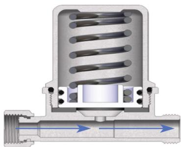
1. Водоразборные краны открыты - давление жидкости не воздействует на поршень и пружину.
