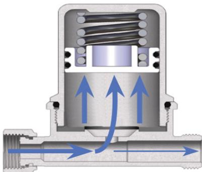
2. При резком закрытии крана затухание избыточного давления происходит через воздушную камеру и стальную пружину, которая, противодействует силе жидкости, поглощая большую часть избыточного давления.
