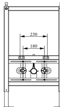
7. Отрегулируйте и зафиксируйте положение сливной канализационной трубы.
