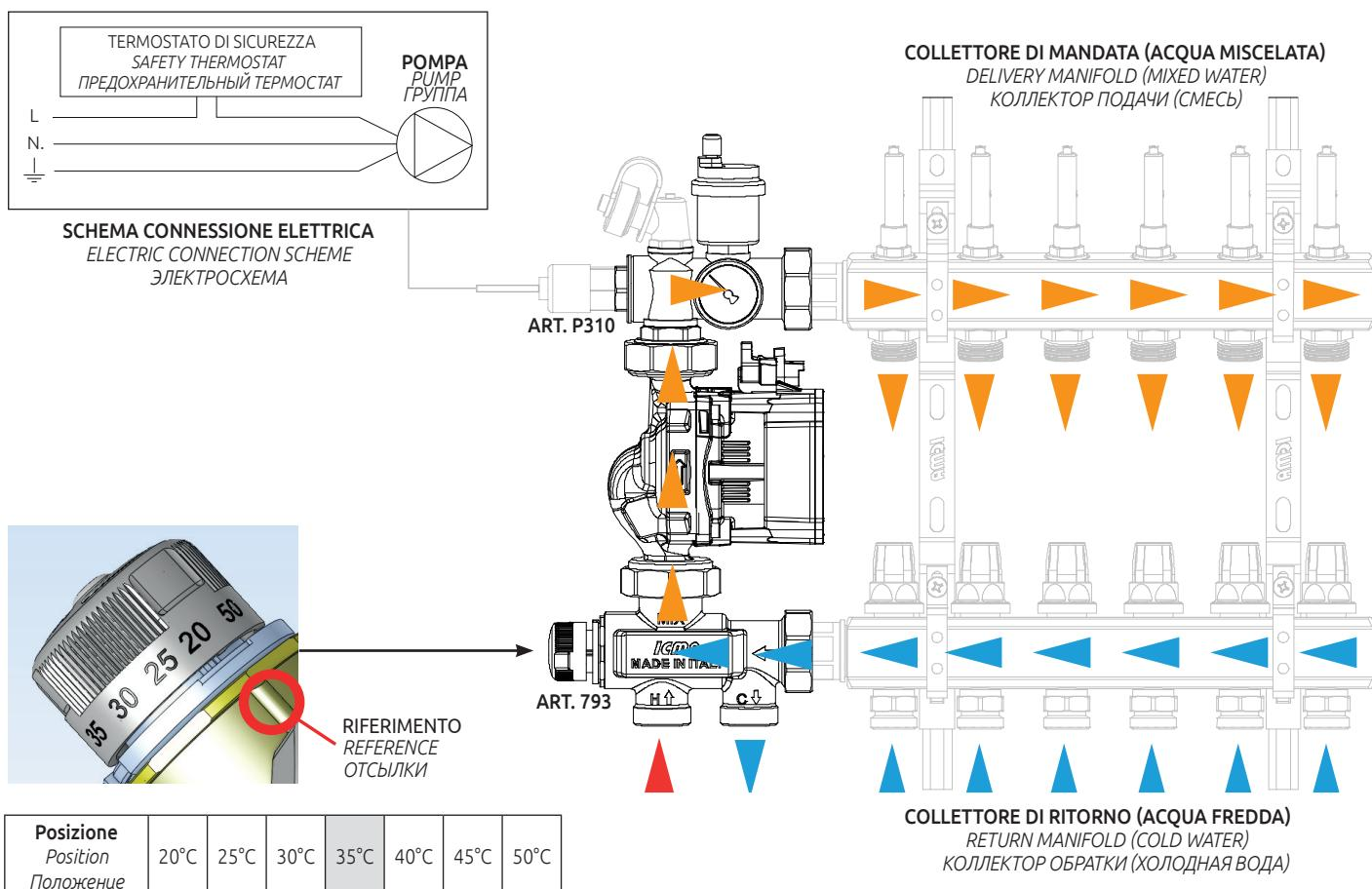
**ATTENZIONE!** Prevedere l'installazione di un filtro a Y (grado di filtrazione 200 µm - codice articolo: 83050AF05200) all'ingresso della valvola miscelatrice per prevenire possibili ostruzioni dovute alla presenza di impurità all'interno dell'acqua d'impianto.
