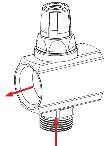
Кран-буфера служит для перекрытия потока теплоносителя в отдельно взятом контуре. Подходит для использования с электротермическим сервоприводом (резьба M28) на обратной линии. Жидкость всегда поступает из ответвлений.
