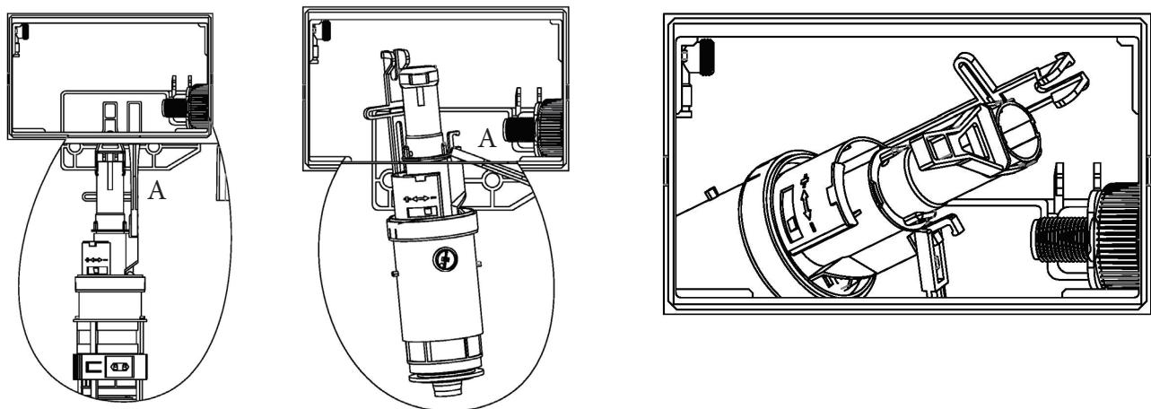
6.4 Обслуживание наливного клапана
