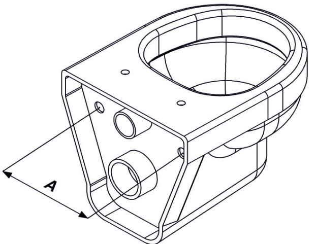
6. Установить шпильки в зависимости от межосевого расстояния:
