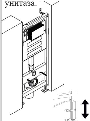
2. Разметка отверстий для крепления рамы к задней стенке и полу.
