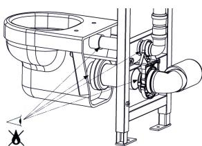
8. Установить унитаз, предварительно обработав резинки силиконовой смазкой.
