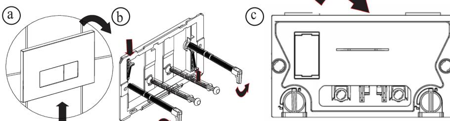
a. Нижнюю часть панели сдвинуть вверх. Панель сверху тянуть на себя.
